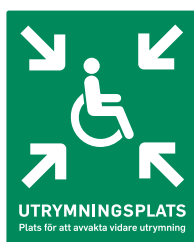
Figur 6. Skylt inom utrymningsplats enligt Arbetsmiljöverket (AFS 2020:1).
